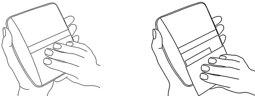
Nehmen Sie die Hülle ab und drücken Sie mithilfe eines dünnen Gegenstandes, z. B. einer gerade gebogenen Büroklammer, auf die eingelassene RESET Taste.
