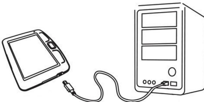
**Achtung!** Trennen Sie das Gerät nicht vom PC bis alle Dateien kopiert werden, sonst können Funktionsstörungen auftreten. Es ist empfehlenswert, «eine sichere Entfernung des Gerätes» vor dem Trennen des USB Kabels durchzuführen.
