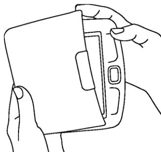
Um die Schutzhülle zu schließen, halten Sie das PocketBook 360° Plus mit einer Hand fest, während Sie die Schutzhülle mit der anderen Hand festhalten, und setzen Sie die Schutzhülle mit ihrer Innenseite am Gerät an. Drücken Sie sie dann nach unten, bis sie sanft einrastet. Die Ansätze dienen zum Lösen der Schutzhülle. Drücken Sie dazu auf einen der Ansätze.
