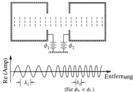
Fig. 7-3: Die Amplitude für ein Teilchen, das von einem Potential zu einem anderen übergeht.
