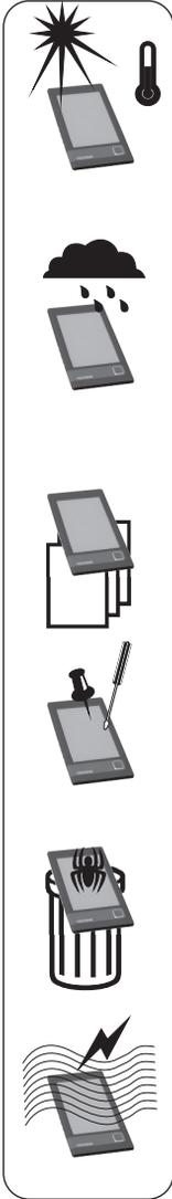
Setzen Sie das Lesegerät nicht über einen längeren Zeitpunkt direkter Sonneneinstrahlung aus! Bitte beachten Sie, dass die Arbeitstemperatur des Gerätes zwischen 0° C und 40° C liegt.
