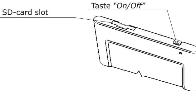
Um das Gerät einzuschalten, drücken Sie die Taste "On/Off" 1 Sekunde lang.
